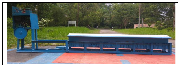
Gambar 1. Peralatan pembangkit listrik menggunakan speed bump [5]
