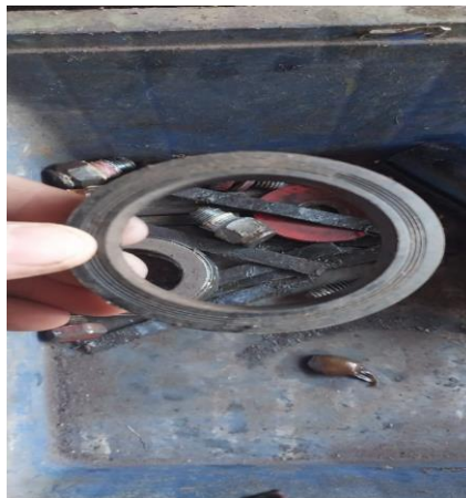
Gambar 2.2 seal katup mengalami kerusakan kehilangan elastisitas dan perubahan warna
