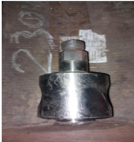
Gambar 2.3 plug katup mengalami keausan & kurang pelumasan.
