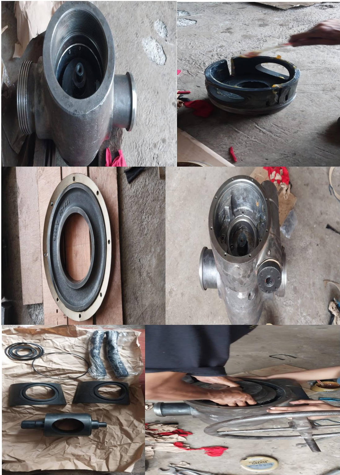
Gambar 2.4 Foto gabungan komponen komponen & proses pemasangan katup API
