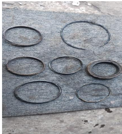
Gambar 2.1 seal katup yang mengalami kerusakan dengan kondisi putus, retak & perubahan warna
