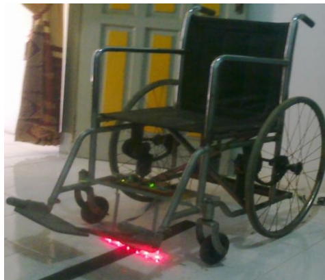
Gambar 2. Letakkan sensor proximity di atas garis hitam
