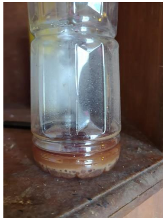
Gambar 4. Bahan Bakar Hasil Destilasi Limbah Oli
