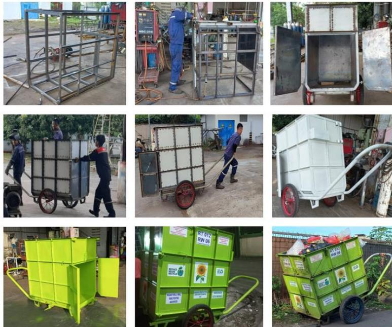
**Gambar 5.** Proses Pembuatan Langsung Gerobak Sampah Hasil Modifikasi
